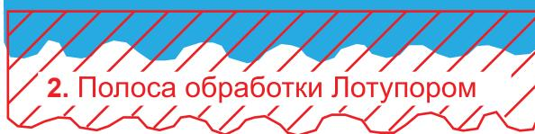
Начните пропитку сверху. Дайте при нормально-всасывающих фасадах Лотупору стечь, примерно на 30-50 см. Сместите процедурные полосы вниз примерно на половину высоты стекания, чтобы получить уверенное перекрытие пропитанных площадей. Если Вы разбрызгиваете, то действуйте также. Проверьте расход! При слишком большом расходе сократите высоту перехода!
