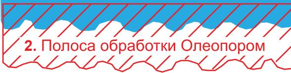
Начните пропитку сверху. Дайте при нормально-всасывающих фасадах Олеопору стечь, примерно на 30-50см. Сместите процедурные полосы вниз примерно на половину высоты стекания, чтобы получить уверенное перекрытие пропитанных площадей. Если Вы разбрызгиваете, то действуйте также. Проверьте расход! При слишком большом расходе сократите высоту перехода!
