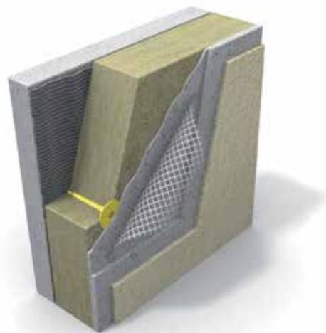
При производстве теплоизоляционных работ необходимо соблюдать определенные правила. Перед началом монтажа необходимо зачистить изолируемую поверхность фасада. Затем обработать её праймером и дать поверхности полностью высохнуть. И уже после этого можно приступать к креплению теплоизоляционных плит или ламелей PAROC LINIO.
