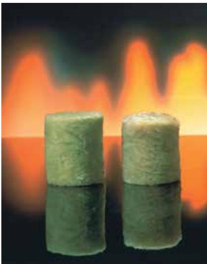
Каменная вата PAROC устойчива к воздействию высоких температур. На рисунке изображены образцы ваты PAROC до и после испытаний на негорючесть по стандарту ГОСТ 30244 м.1. Температура внутри печи в процессе проведения теста равна 750°C. Образец выдерживает воздействие высокой температуры на протяжении 30 мин, не меняя своей формы и сохраняя практически неизменной свою массу.
