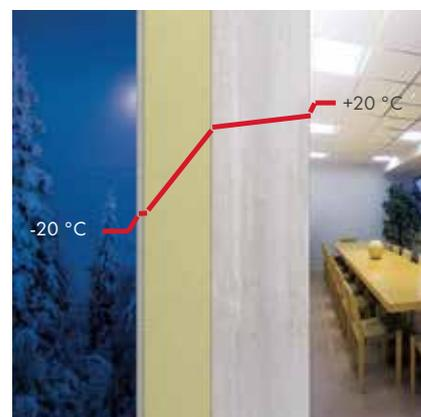
Температуру на внутренней поверхности несущей (кирпичной, бетонной) стены можно повысить путем существенного увеличения ее толщины. Оптимальное решение – рассчитать толщину несущей стены, исходя из нагрузок, а требования по теплозащите обеспечить за счет применения фасадной изоляции PAROC LINIO.
