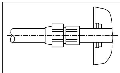
**5. Připojení větrací a kabelové trubky**
