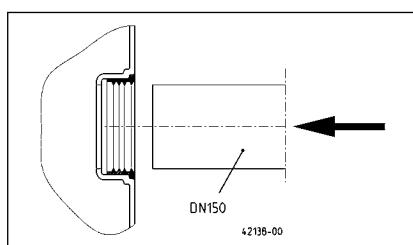
**4. Připojení tlakového potrubí**
