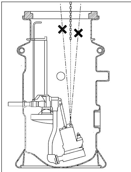
**POZOR!** Před spuštěním čerpadla musí být kulový kohout uzavřený.
