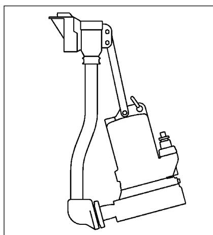
**ATTENTIE!** Voor het inhangen van de pomp de ev. ingedronken aarde, grind of zand uit de schacht verwijderen.
