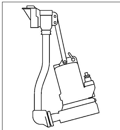
**FIGYELEM!** A pumpa felakasztása előtt az esetlegesen beszöródott földet, kavicsokat, vagy homokot távolítsa el az aknából.
