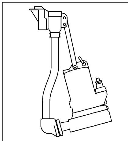
**ACHTUNG!** Vor dem Einhängen der Pumpe die evtl. eingedrungene Erde, Kies oder Sand aus dem Schacht entfernen.
