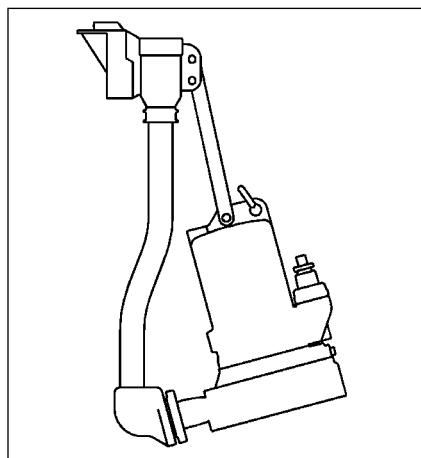
**POZOR!** Pred zavesením čerpadla, odstráňte prípadne do šachty vniknutú zeminu, štrk alebo piesok.
