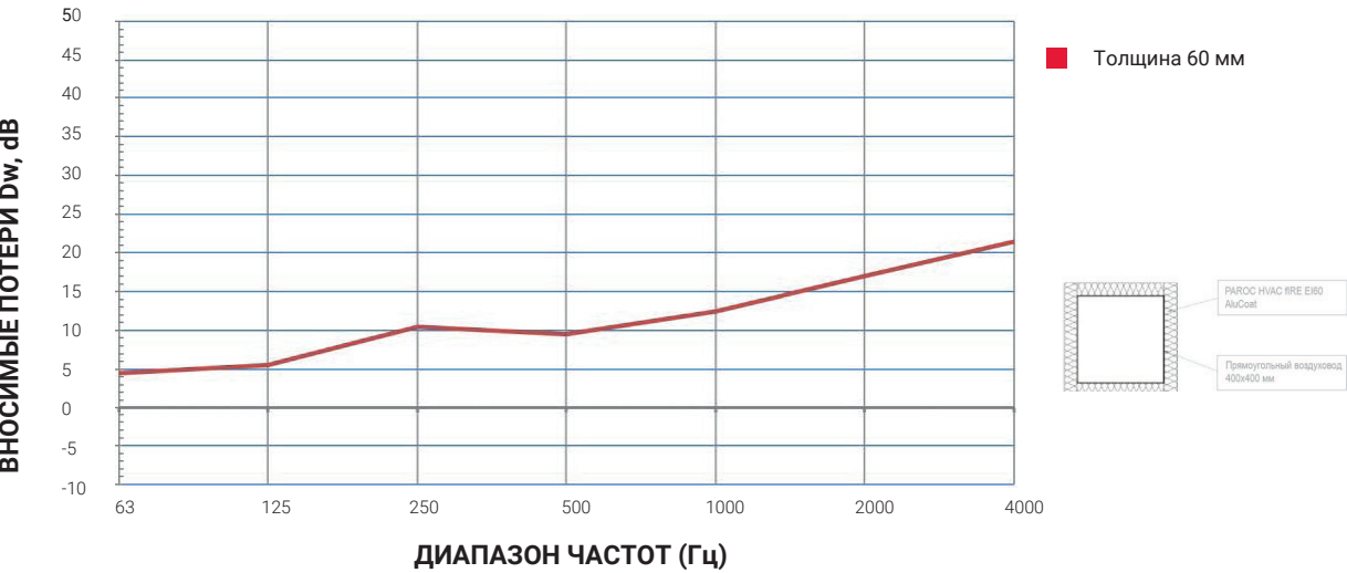
PAROC Hvac Fire Slab EI60 AluCoat, прямоугольный воздуховод 400x400 мм
