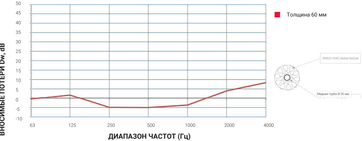
PAROC Hvac Section AluCoat T, медная труба Ø35 мм
