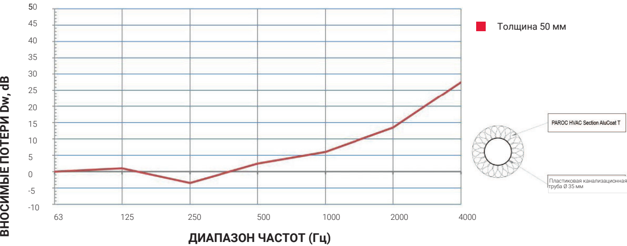
PAROC Hvac Section AluCoat T, пластиковая канализационная труба Ø110 мм
