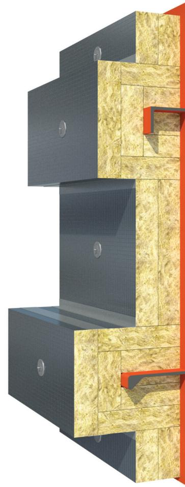
СХЕМА МОНТАЖА ПРОТИВОПОЖАРНЫХ КОНСТРУКЦИЙ
