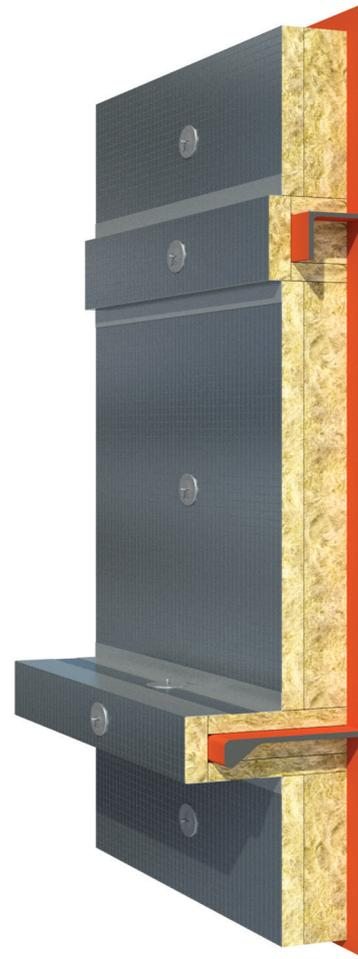
СХЕМА МОНТАЖА ПРОТИВОПОЖАРНЫХ КОНСТРУКЦИЙ
