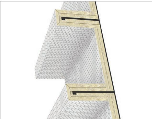
Пример конструкции стальной переборки класса Н120, изолированной PAROC Marine Fire Slab 100 G1. Толщина изоляции переборки и набора 60 + 60 мм.
