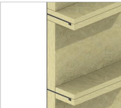
Пример конструкции стальной переборки класса А-60, изолированной PAROC Marine Fire Slab 100 и блоками для набора PAROC Marine Fire Slab 100 Pulb. Толщина изоляции по плоскости 75 мм, по набору 25 мм.
