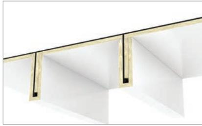
Пример конструкции стальной палубы класса А-30, изолированной PAROC Marine Fire Slab 100 G1 и блоками для набора PAROC Marine Fire Slab 100 G1 HPL. Толщина изоляции по плоскости и по набору 25 мм.
