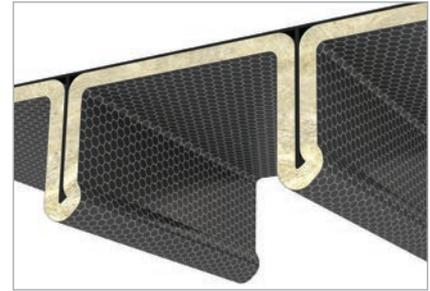
Пример конструкции стальной палубы класса А-15, изолированной PAROC Marine Wired Mat 80 G2. Толщина изоляции 30 мм.
