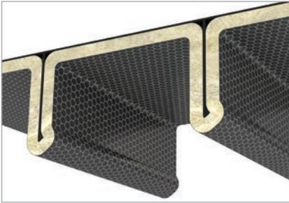
Пример конструкции стальной палубы класса А-60, изолированной PAROC Marine Wired Mat 100 G2. Толщина изоляции 40 мм.
