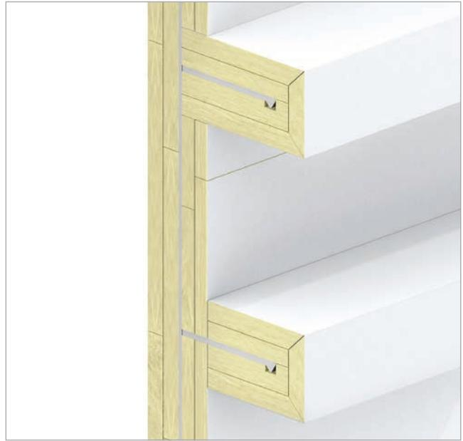
Пример конструкции алюминиевой переборки класса А-60, изолированной PAROC Marine Fire Slab 100 G1. Толщина изоляции 30 + 30 мм с обеих сторон.
