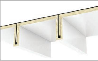
Пример конструкции стальной палубы класса А-60, изолированной PAROC Marine Fire Slab 100 G1 и блоками для набора PAROC Marine Fire Slab 100 G1 HPL. Толщина изоляции по плоскости 50 мм, по набору 25 мм.
