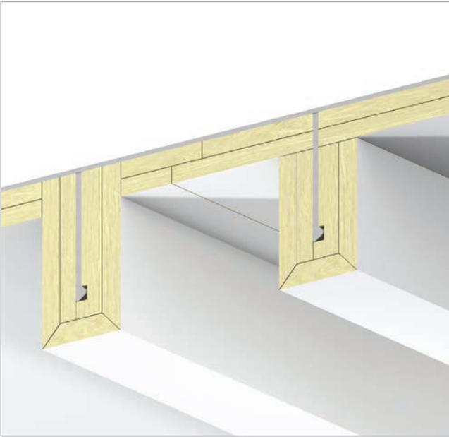
Пример конструкции алюминиевой палубы класса А-60, изолированной PAROC Marine Fire Slab 100 G1. Толщина изоляции 25 + 25 мм.
