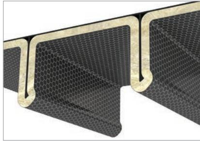
Пример конструкции стальной палубы класса А-30, изолированной PAROC Marine Wired Mat 80 G2. Толщина изоляции 30 мм.
