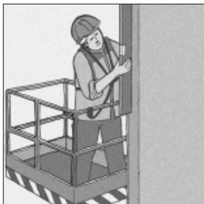
9. Закрепите панель в верхней опорной конструкции и в цокольном профиле. Винты не должны быть затянуты слишком плотно. Используйте шуруповерт или дрель с ограничителем глубины заворачивания.
