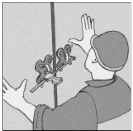
5. Прикрепите панель винтами к профилю пола. Если конструкция относится к огнестойким, то панели длиной более 3,5 м должны крепиться через противопожарный профиль в верхней части панели.
