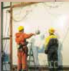
В ходе испытаний на огнестойкость проверяются свойства сопротивления ударной нагрузке. Стыки панелей не дают дыму, газам и пламени проникнуть сквозь противопожарный барьер, образуемый перегородкой.
