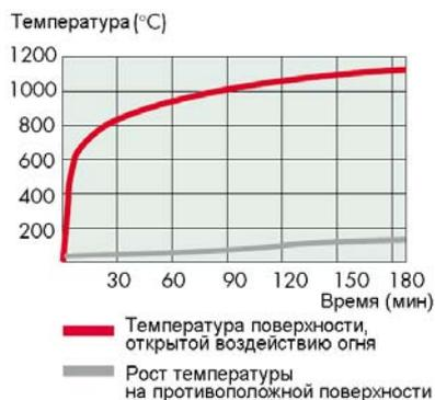
Пример испытания панели Рагос типа 50F 150мм на огнестойкость: по истечении трех часов температура поверхности, открытой воздействию огня, составляла свыше 1100°C, в то время как повышение температуры противоположной поверхности составило менее 135°C.
